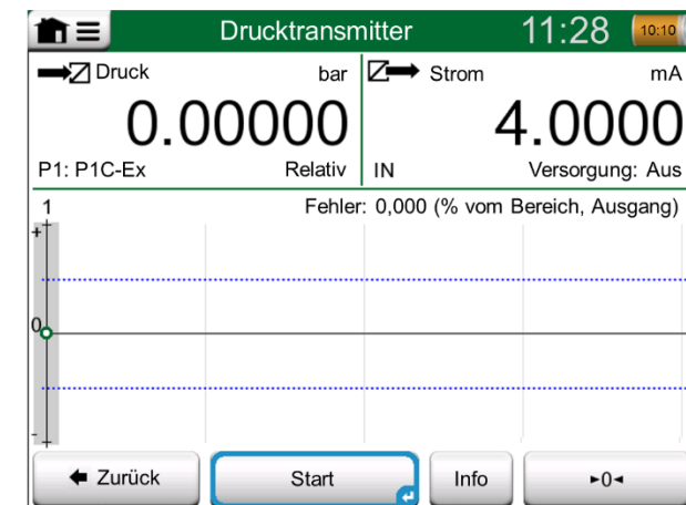
Taste für die Nullstellung eines Druckmoduls rechts unten.
