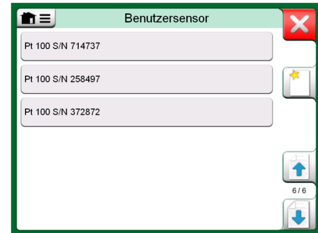
Beispiel einer Liste von PRT-Sensoren, die vom Benutzer im MC6 angelegt wurden.
