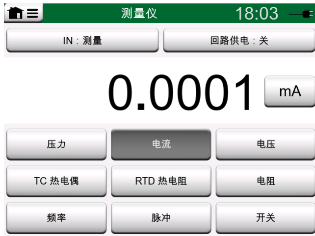
图 46：使用测量仪测量电流
